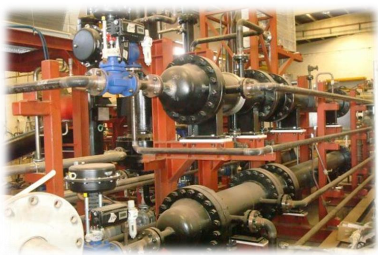
Imagen planta piloto para el proceso del Hydro-gasificación catalítica por plasma (CHGP) para el tratamiento de residuos voluminosos, desarrollada por el socio Blue Plasma Power.
